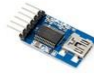
FT232RL FTDI MINI USB TO TTL MWC PROGRAMMER
