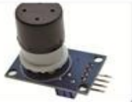
MQ131 OZONE GAS SENSOR ADC
