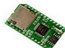
WT5001M02 28PIN MP3 MODULE
