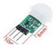
PYRO MINI PIR MOTION SENSOR DIGITAL
