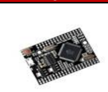
ATMEGA2560 PRO CH340G USB IC
