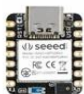
XIAO NRF52840 SENSE TINYML TENSORFLOW LITE
