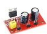
LM4863 5V MINI 3W DUAL AMPLIFIER BOARD
