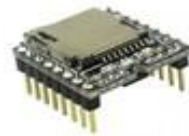
MP3-TF-16P DF MINI MP3 SDCARD MODULE
