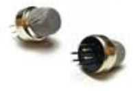
MQ4 METAN MODULE ADC
