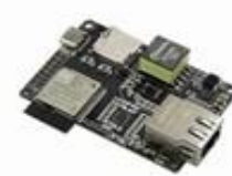
TTGO T-INTERNET-POE ESP32-WROOM LAN8720A ETHERNET
