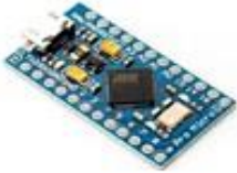
PRO MICRO MINI LENONARDO 5V 16MHZ BOARD
