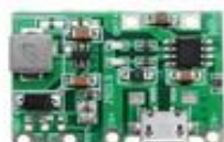
3.7V TO 5-9V 18650 2A STEP UP ADJUSTABLE MODULE
