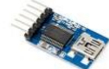
FT232RL FTDI MINI USB TO TTL MWC PROGRAMMER
