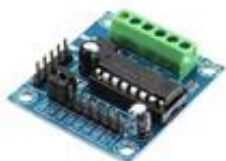
MINI L293D MOTOR DRIVE MODULE-TN-6989
