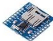
DS1307 MINI RTC MICRO SD MODULE WEMOS D1
