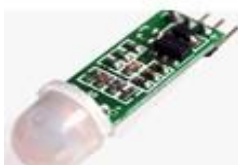
HC-SR505 MINI PIR MOTION SENSOR DIGITAL
