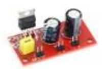
LM4863 5V MINI 3W DUAL AMPLIFIER BOARD
