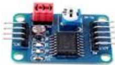
PCF8591 ANALOG DIGITAL AD DA MODULE
