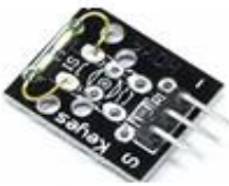
KY-021 MINI DRY REED SWITCH SENSOR
