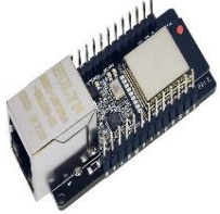
WT32-ETH01 ETHERNET ESP32 MODULE
